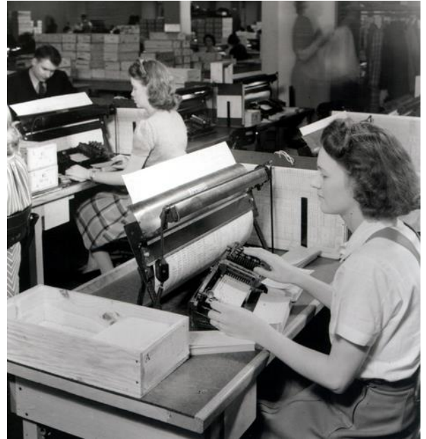
Figura 13 - Sopra, una tipica macchina per il conteggio delle schede; a destra, ufficio di perforazione schede
