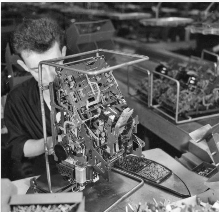
Un'altra delle innumerevoli e complesse operazioni di assemblaggio dei vari componenti di una MC 24.
