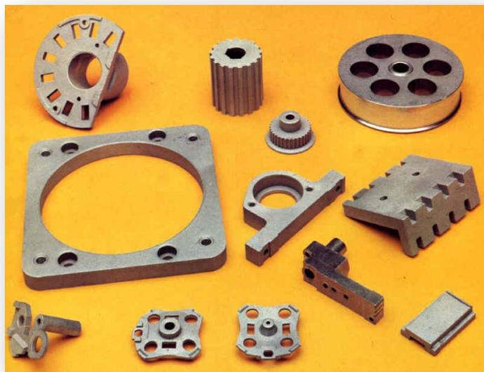
Componenti prodotti con sinterizzazione da Olivetti, con tecnologie sviluppate in proprio. Nel 1979 le attività aziendali impegnate nella produzione di componenti sinterizzati venne fatto confluire in una nuova società del Gruppo Olivetti: TecSinter.
