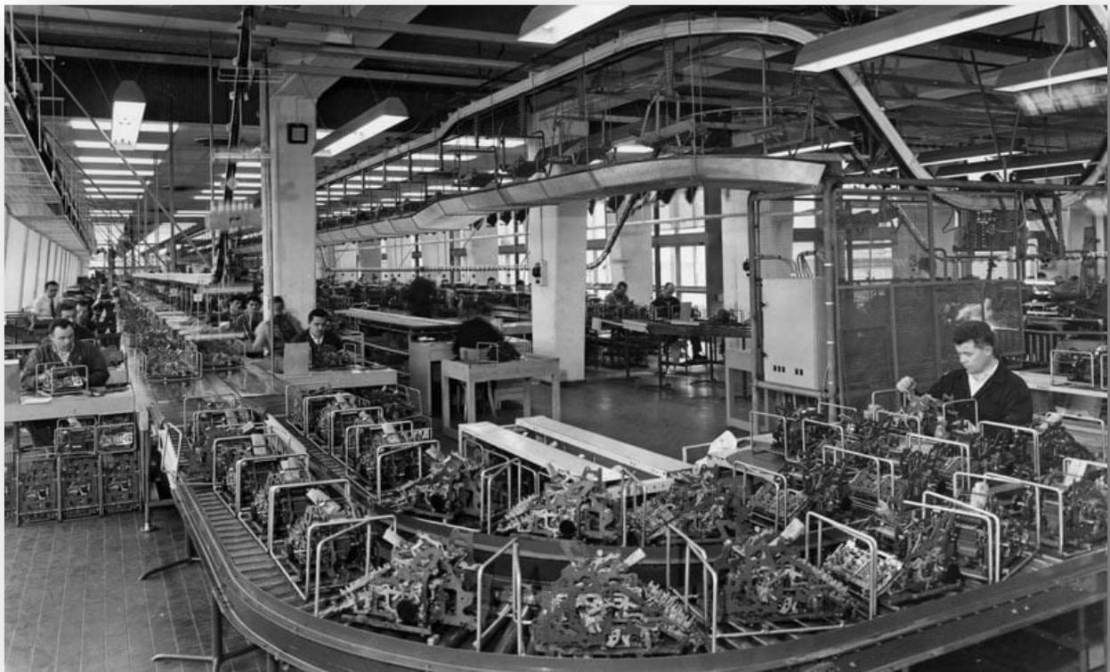
La linea di produzione delle MC 24; notare come ogni apparecchio sia accompagnato dal cartellino delle lavorazioni, su cui ciascun operaio doveva porre la firma a testimonianza dell'esecuzione della propria fase (oltre 60 fasi di montaggio).
