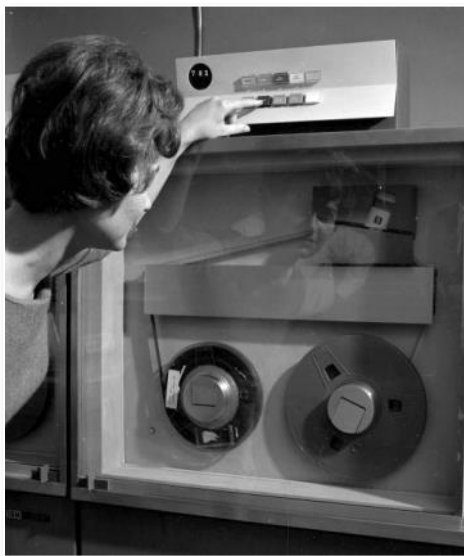
25 - A sinistra l'unità a dischi magnetici rimovibili e, a destra, l'unità a nastro magnetico. Sui dischi venivano archiviati i dati d'uso corrente, sui nastri i dati "storici"
