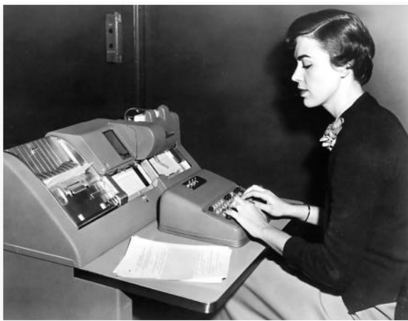
17 – Perforazione di schede con apparecchio elettromeccanico
